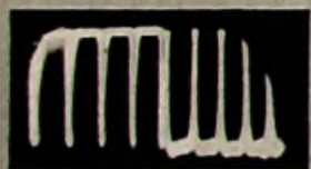
Abb. 19. Stark zeitgedehnter Vertikalimpuls
