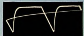
Abb. 9. Getriggerte Kippspannung mit schwacher Zeitdehnung
