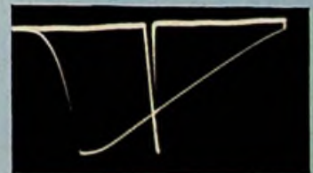
Abb. 10. Getriggerte Kippspannung mit starker Zeitdehnung
